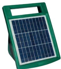
12 volts pour une utilisation mobile, optimisé pour un fonctionnement continu livré avec panneau solaire 8 Watts, 1 batterie 12 Volts 4 Ah, 1 bloc d'alimentation 230 Volts pour le rechargement de la batterie en cas de besoin ou le maintien de charge en hiver, 1 piquet de terre, câbles de connexion terre et clôture et pancarte de signalisation.
